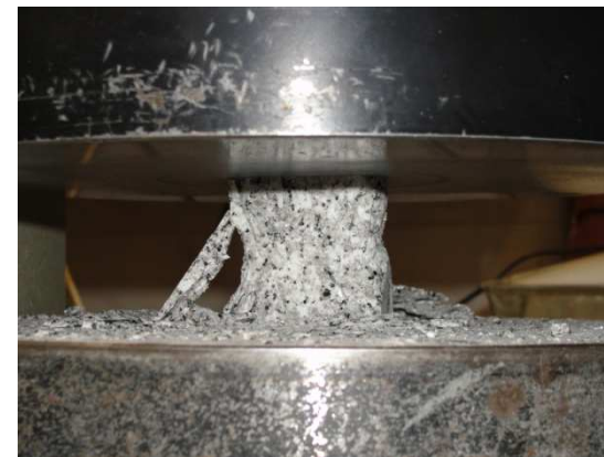
Badanie wytrzymałości na ściskanie kostki granitowej.
