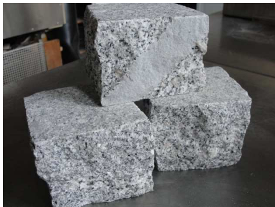
Kostki granitowe z płomienowaną warstwą licową.
