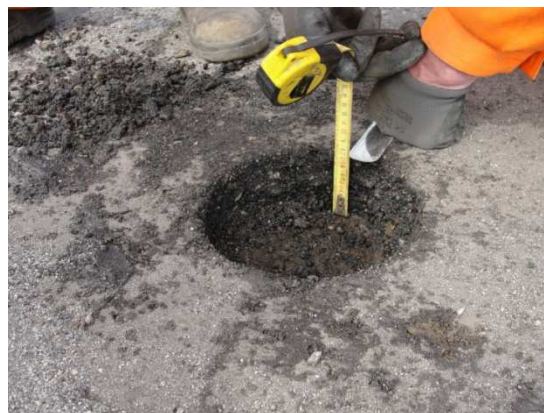
Pomiar grubości warstwy ścieralnej.
