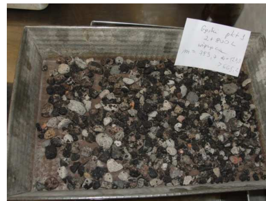
Brak otoczenia kruszywa lepiszczem.
